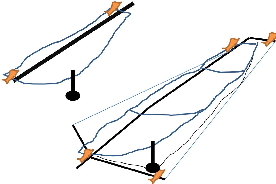
Segel am Hals und Top mit Klebeband auf Tisch fixieren. Vorgespanntes rigg mit Klebeband auf Segel und Tisch fixieren. Segel am Schothorn aufstellen und gewueschter Twist und Bauch simulieren. Mastkurve auf Segel uebertragen. Fertig! Beim Fock kann anstelle des Riggs eine Masstab verwendet werden.
