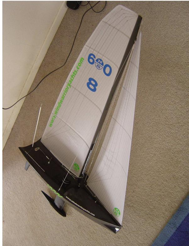
Zwei verschiedene Perspektiven des gleichen Modells: Drehbarer Flügelmast und ein riesiges durchgelattetes Großsegel sind die auffälligsten Merkmale der NS 600 mit der Baunummer 8 und dem Namen STACEY JONES. Sie ist benannt nach einem legendären neuseeländischen Rugby-League-Spieler aus der Mannschaft „The Warriors“.
