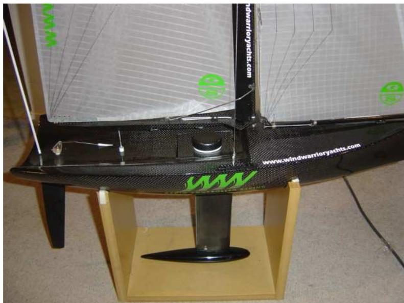
Perfektes Finish zeichnet die Kohlefaserkonstruktion von Grant (Grunta) McKinnon aus. Gut zu sehen ist der „Niederdrücker“ (engl.: compression vang), der einen sehr tief liegenden Baum ermöglicht.
